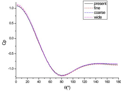
**FIGURE 3:** THE TIME AVERAGE DISTRIBUTION OF PRESSURE COEFFICIENT ON THE CYLINDER WITH PRESENT GRID, FINE GRID AND WIDE DOMAIN
