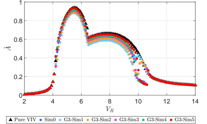
**FIGURE 5: CHARACTERISTIC OSCILLATION AMPLITUDE CURVE. GROUP 3.**
